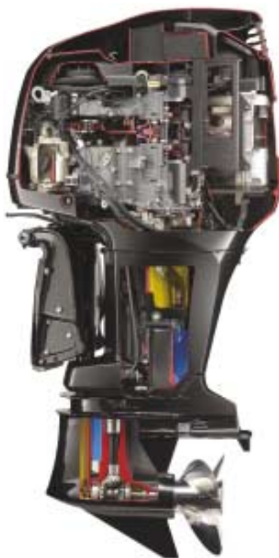
Presjek DF 300, okretomjer s digitalnim pokazateljem, koji sadrži niz informacija; ručice elektronskih komandi motora
